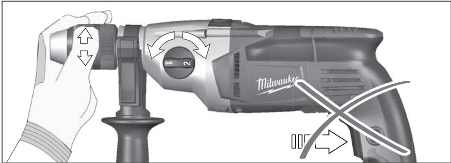
开机器后千万不可以使用换档器，待机器完全静止时才可以换档。
